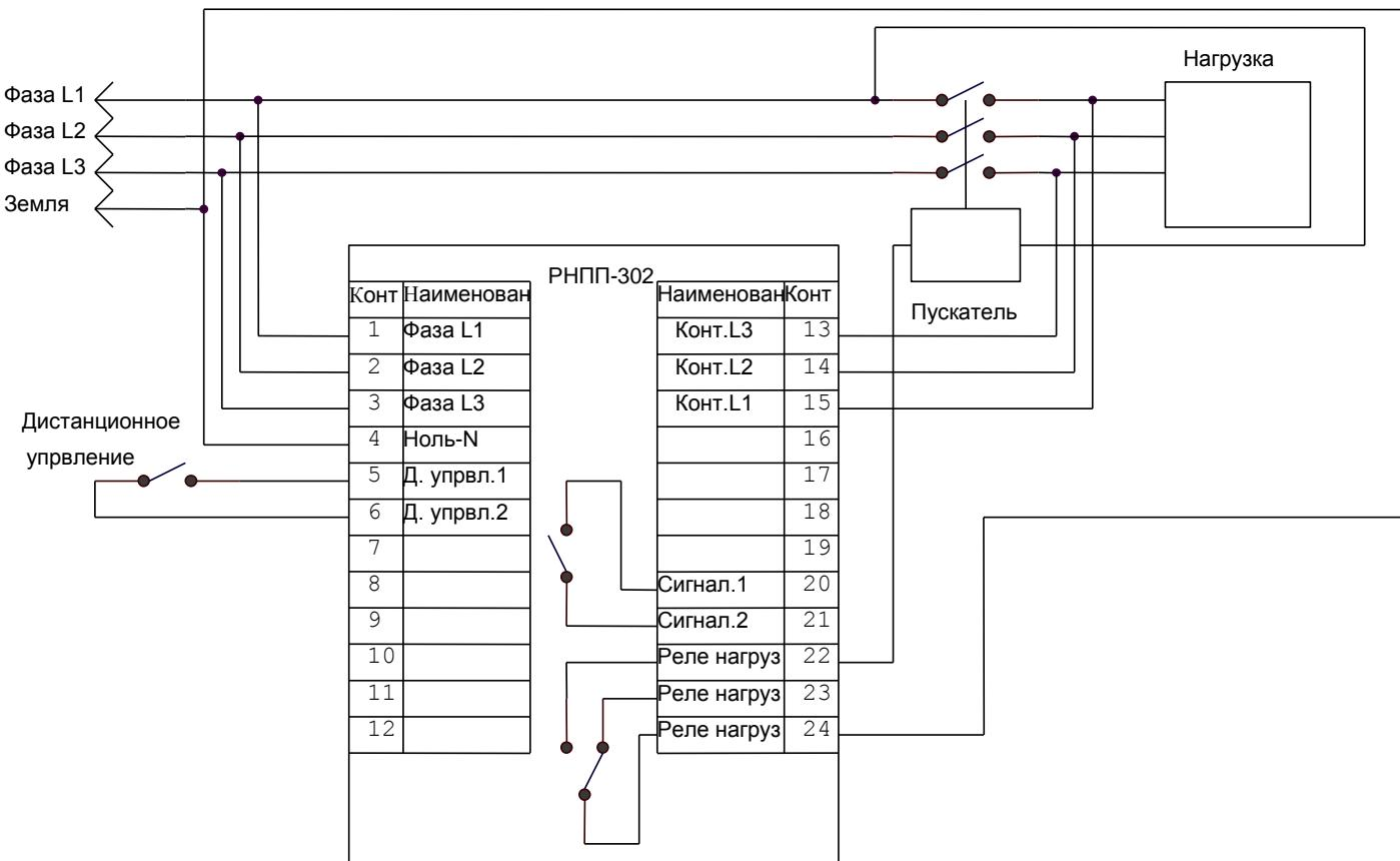
**П р и м е ч а н и е** - При подключении реле в сети с изолированной нейтралью, ноль-N (клетка 4) можно не подключать.
